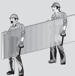
La movimentazione manuale del singolo elemento dovrà sempre essere effettuata sollevando l'elemento stesso senza strisciarlo su quello inferiore e ruotandolo di costa a fianco del pacco; il trasporto dovrà essere effettuato almeno da due persone in funzione della lunghezza, mantenendo l'elemento in costa (vedasi figura).
