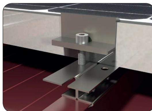
Il fissaggio è punto di forza del sistema Dryfix™ - permette di realizzare una copertura ventilata senza forare i pannelli coibentati metallici pur mantenendo caratteristiche meccaniche di adeguata resistenza alle sollecitazioni. Dryfix™, (nome prodotto che si ispira alle sue proprietà: fissaggio asciutto e sicuro) senza fori passanti può collegare tegole, tavolati, listelli, pannelli solare termici o moduli fotovoltaici.
