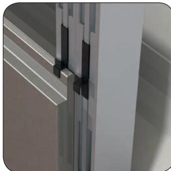
Il fissaggio è il punto di forza del sistema Air-fix™ - permette di creare una parete ventilata senza forare i pannelli coibentati metallici pur mantenendo caratteristiche meccaniche di adeguata resistenza alle sollecitazioni, in questo modo il sistema riduce sensibilmente la presenza di ponti termici che possono presentarsi nella parete. Air-fix™, (nome prodotto che si ispira alle sue proprietà: fissaggio asciutto e ventilazione) senza fori
