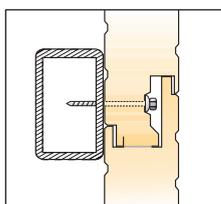
Grazie alla perfetta configurazione del giunto, oltre a rendere piacevole ed uniforme la superficie dell'involucro edile, il pannello Isolpack è in grado di abbattere considerevolmente i ponti termici che, come è noto, sono causa di dispersione energetica e formazione di condensa.
