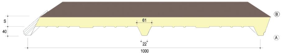
I pannelli Isolpack DECK si distinguono per la loro caratteristica greca rivolta verso il basso, che li rende ideali per la realizzazione di coperture piane, leggere, dall'ottimo isolamento e con semplicità di impiego.
