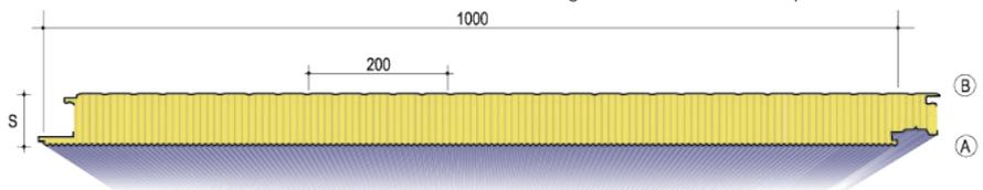
**Prodotto:** pannelli metallici precoibentati con isolamento in fibra minerale per pareti (disponibili anche nella versione con supporto interno forato).
