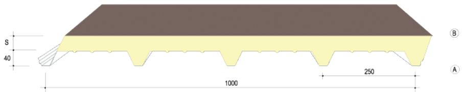
Le coperture ISOLPACK DECK sono prodotte in continuo con un supporto metallico in acciaio zincato e un supporto all'impermeabilizzazione in cartongesso bitumato sul quale potranno essere applicate le diverse guaine impermeabilizzanti per la protezione della copertura.
