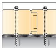
Grazie alla perfetta configurazione del giunto, oltre a rendere piacevole ed uniforme la superficie dell'involucro edile, il pannello Isolpack è in grado di abbattere considerevolmente i ponti termici che, come è noto, sono causa di dispersione energetica e formazione di condensa.
