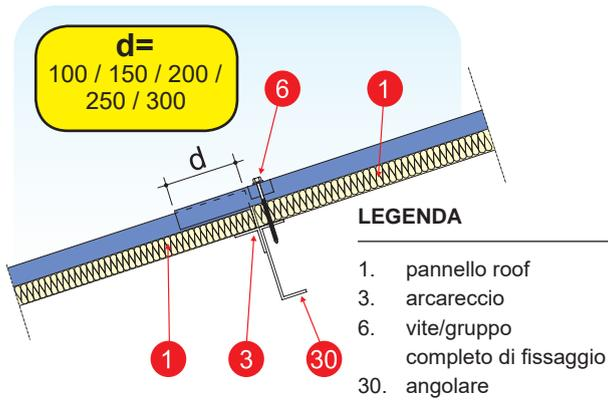
I pannelli, su richiesta, possono essere forniti e tagliati della lunghezza desiderata. Se la lunghezza del tetto è tale da dover essere utilizzato più di un pannello, si adotta la tecnica dell'overlapping, in questo caso l'isolante interno deve essere rimosso. (nelle figure)
